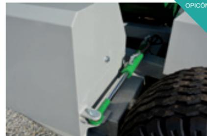
Peso lateral hidráulicamente pivotante
