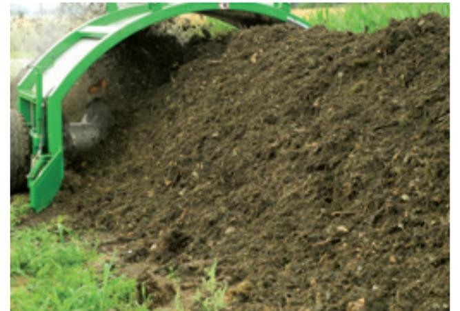
Con la TG 301 se consigue fácilmente y rápidamente un compostaje exitoso. Esto se debe en gran parte al eje de volteo que trabaja perfectamente y que mueve el material desde el interior hacia el exterior.
