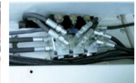
Válvula de control electrohidráulica con panel de control; (simple, doble o triple)
