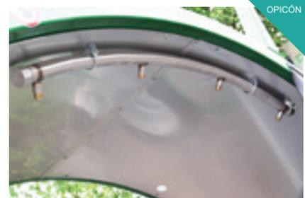
Barras aspersión de agua con pulverizadores. Para la obtención de un clima óptimo para los microorganismos dentro de la pila, la adición de agua es indispensable.
