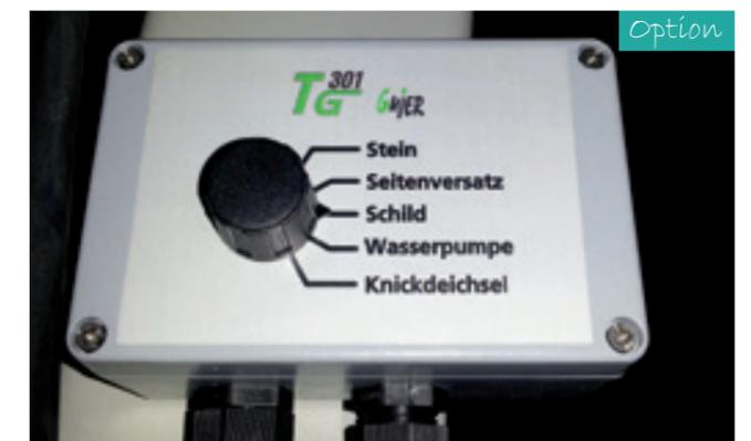
Fácil manejo a través de panel de control. Conmutación a través de electroválvulas.
