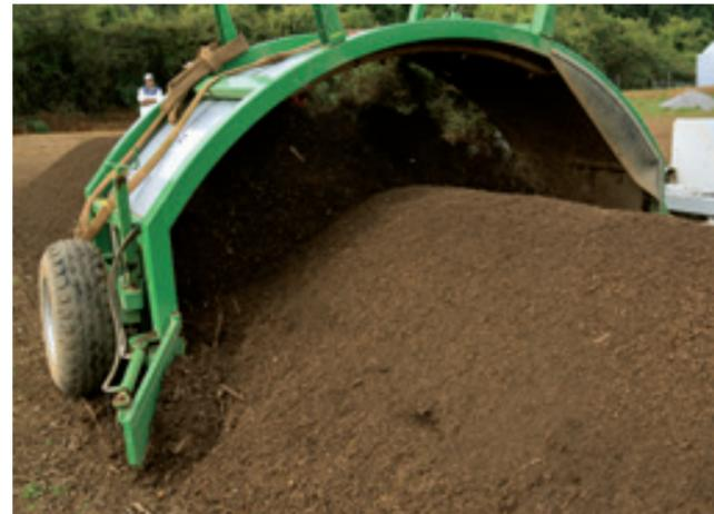
La TG 301 es una volteadora de compost fácil de usar, de accionamiento mecánico – estable y maniobrable con una óptima distribución del peso. Ideal para el compostaje en el borde del campo, en plantas pequeñas y fincas ecológicas con un compostaje hasta 6'000 toneladas por año.
