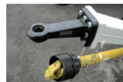
Enganche de remolque estándar frontal: acoplamiento DIN
