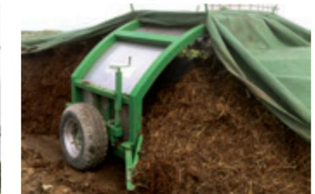
La tela de cubierta se junta en un ancho menor para que los gases puedan escaparse. Se evita el duro trabajo manual en caso de tela mojada.
