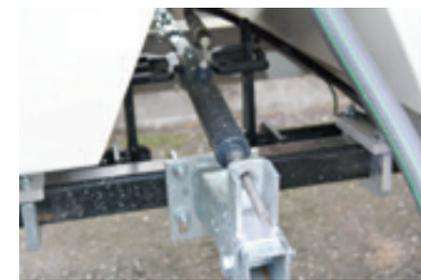
Freno de remolque hidráulico
