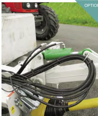
Réglage de la hauteur simplifié pour que le rotor puisse travailler au ras du sol sans laisser une couche de pourriture au sol.
