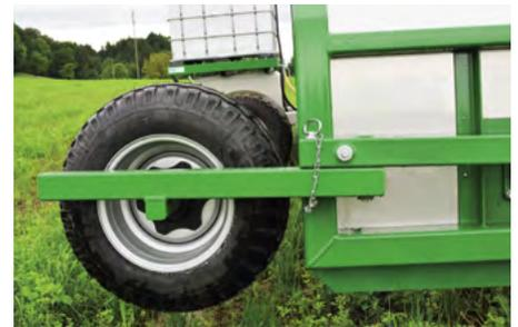
Pour le transport la roue de support peut être repliée. Pas de démontage nécessaire
