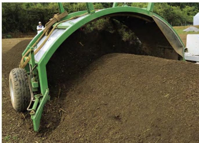
Le TG 301 est un retourneur de compost avec entrainement mécanique facile d'utilisation – robuste et maniable avec une répartition de poids optimale. Idéalement conçu pour le compostage au bord de champs, petite plateforme de compostage et des fermes biologiques. Jusqu'à 6000 tonnes annuels avec un tracteur.
