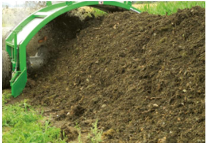
Mit der TG 261 & 301 gelingt das Kompostieren einfach und schnell. Dies liegt vor allem an der perfekt arbeitenden Umsetzwellen, die das Material von innen nach aussen fördert.
