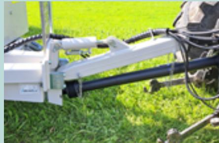
Hydraulische Knickdeichsel - Obenanhangung
