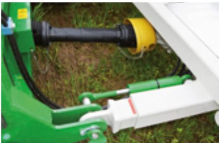
Direkter Antrieb – Getriebe auf Umsetzwelle
