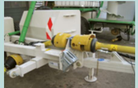
Untenanhängung für Tiefzug für Hitch mit Piton oder K80.
