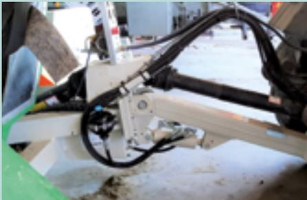
Hydraulische Knickdeichsel - ab Traktor mit Sperrblock (Bild: Tiefzug mit Schwingungsdämpfer)
