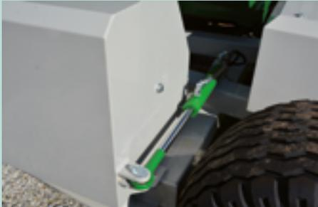
Seitengewicht hydraulisch schwenkbar
