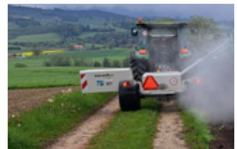
Dank dem Schwenkgewicht ist auch das Befahren einer Wiese möglich. Ausserdem sorgt es für eine optimale Gewichtsverteilung und verringert das Gesamtgewicht der Maschine um ca. 1'500 kg.
