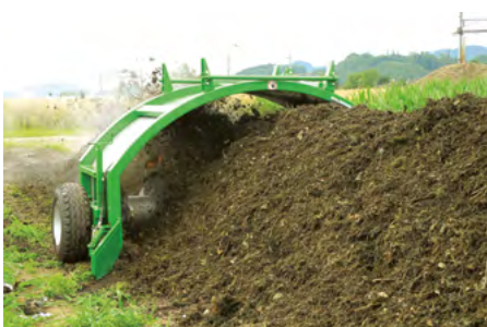
Maximale Mietengrösse: 3.2 x 1.5m (TG 303), damit aerob kompostiert werden kann.
