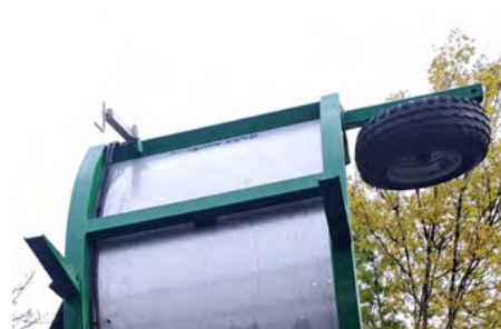
Für den Transport kann das Tastrad weggeschwenkt werden, keine Demontage nötig.
