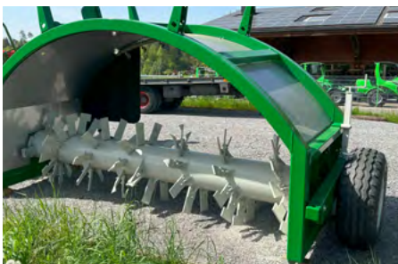
Die massive Bogenkonstruktion aus Stahl sorgt für eine sehr grosse Stabilität.
