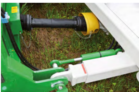
Direkter Antrieb – Getriebe auf Umsetzwelle
