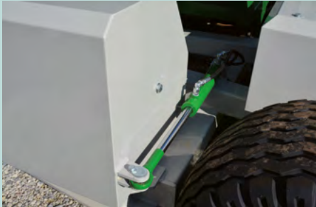
Seitengewicht hydraulisch schwenkbar
