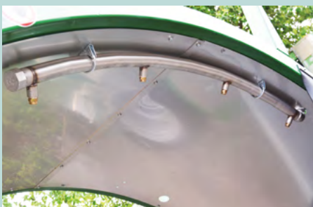
Wasserspritzbalken mit Düsen
