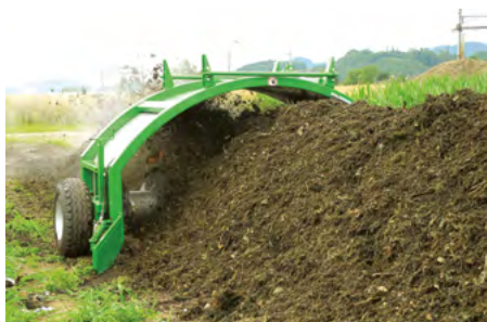
Ideale Mietengrösse , damit aerob kompostiert werden kann: TG 261 -> 2.6 x 1.45m TG 301 -> 3.0 x 1.5 m
