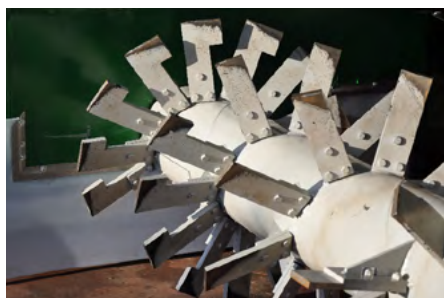
Eine gute Umsetzwelle arbeitet das Material von innen nach aussen. Durch schonendes Umsetzen können sich die Mikroorganismen überall optimal vermehren können.
