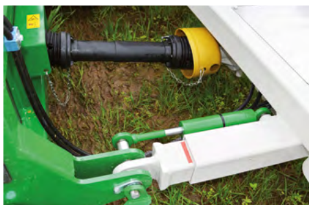
Direkter Antrieb – Getriebe auf Umsetzwelle
