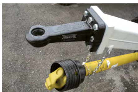
Standard-Anhängerkupplung vorne: DIN- und Hochzug-Deichsel
