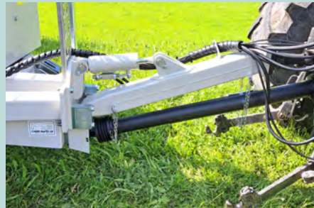
Hydraulische Knickdeichsel - Obenanhängung
