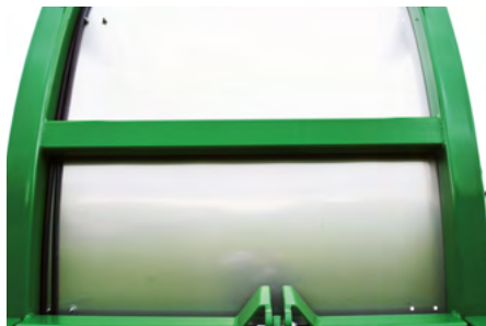
Alle Verschleissbleche sind aus Chromstahl.
