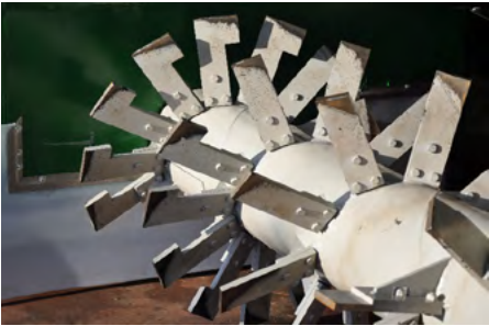
Eine gute Umsetzwelle arbeitet das Material von innen nach aussen. Durch schonendes Umsetzen können sich die Mikroorganismen überall optimal vermehren.
