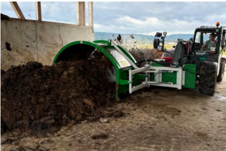
Maximale Mietengrösse: 2.5 x 1.2m, damit aerob kompostiert werden kann.
