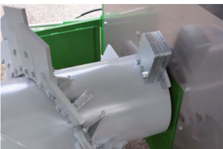
12 mm Schlägerdicke Die gewuchtete Welle sorgt für eine lange Lebensdauer und ruhigen Lauf.
