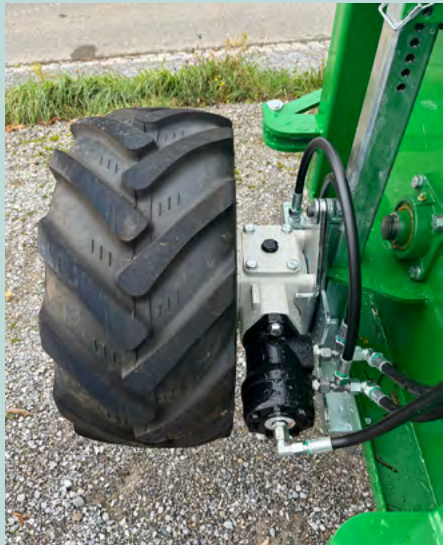
Antriebsrad hydraulisch mit automatischer Regelung.
