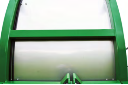
Verschleissbleche sind aus Chromstahl.
