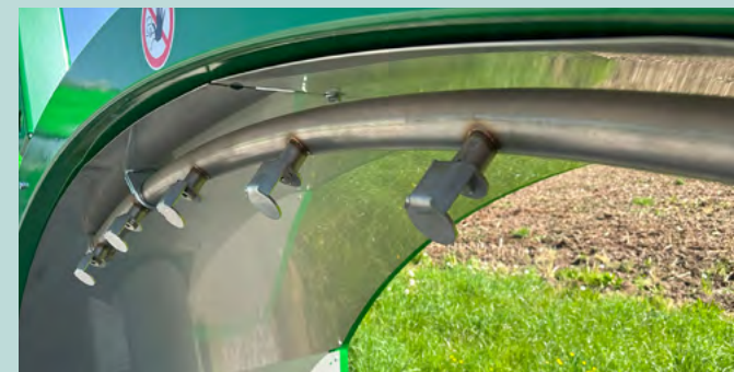
Wasserspritzbalken mit 4 Pralltellern - fragen Sie an für Bewässerungsoptionen
