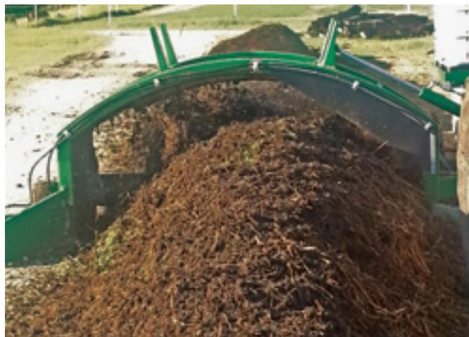
Con la TG 231 se consigue fácilmente y rápidamente un compostaje exitoso. Esto se debe en gran parte al eje de volteo que trabaja perfectamente y que mueve el material desde el interior hacia el exterior.
