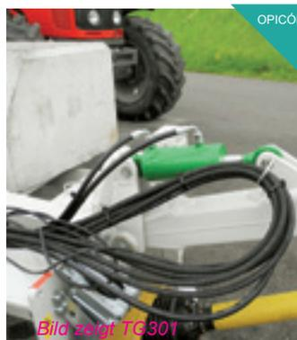
Simple ajuste de altitud para que el rodillo trabaje cerca del suelo y no se pueda formar ninguna capa de putrefacción.
