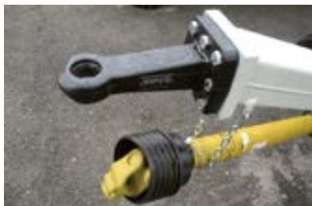
Standard-Anhängekupplung vorne: DIN-Zugöse
