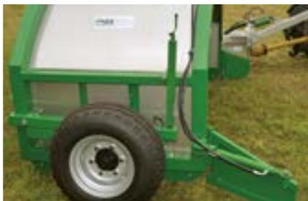
Hydraulisches Zuführschild rechts
