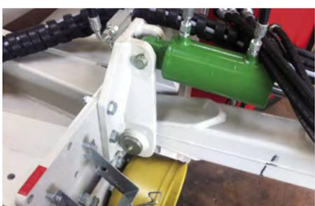
Flèche avec tirant hydraulique
