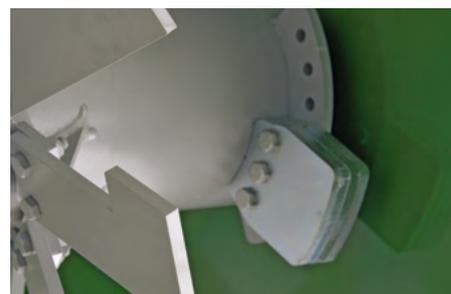
Lames en acier 12 mm fixés avec 3 boulons. L'équilibrage du rotor garantit une longue longévité.
