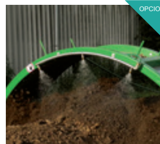
Barras aspersión de agua con pulverizadores. Para la obtención de un clima óptimo para los microorganismos dentro de la pila, la adición de agua es indispensable.
