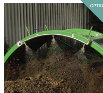
Dispositif d'irrigation avec buses. Double réservoir d'eau. Pour obtenir un climat optimal pour les microorganismes dans l'andain un apport d'eau est essentiel.
