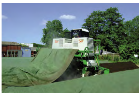
Enrouleur pour bâche hydraulique, réglable en hauteur. Rouleau de bâche avec système d'échange rapide.
