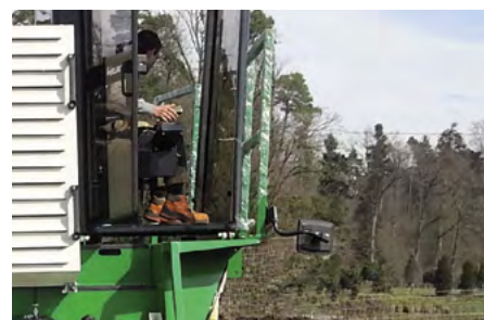
Rétroviseurs pour une vue dégagée sur le rotor.
