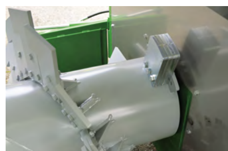
Les lames de 15 mm d'épaisseur sont fixées avec 3 boulons. Le rotor équilibré a une longue durée de vie.
