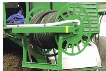
Enrouleur de tuyau avec guide automatique. Il peut de-/enrouler des tuyaux jusqu'à 80 m en fonction de la vitesse d'avancement
