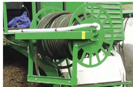
Carrete de manguera con guía de manguera automática. Envuelta mangueras hasta mas o menos 80 metros de forma automáticamente en la velocidad de conducción para arriba y abajo.
