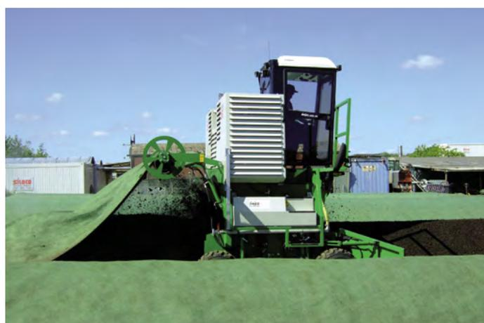
La altura del rodillo Fleece es ajustable hidráulicamente. En una operación se hace el trancplante y al mismo tiempo se depone el Fleece. Con el sistema de cambio rápido, el Fleece se cambia muy fácilmente. Gracias al control remoto opcional puede acompañar el enrollado y desenrollado de la tela Fleece desde el exterior.
