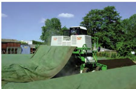
La altura del rodillo Fleece es ajustable hidráulicamente. Rollo Fleece con sistema de cambio rápido.
