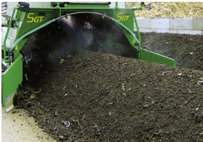
Con la SGF 3100 se consigue fácilmente y rápidamente un compostaje exitoso. Esto se debe en gran parte al eje de volteo que trabaja perfectamente y que mueve el material desde el interior hacia el exterior.
