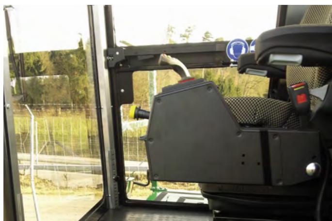
Generoso espacio en la cabina. Con una puerta en la izquierda y la derecha, para la comodidad y la seguridad. Entrada y salida facilitada por el reposabrazos que se puede poner hacia atrás.
