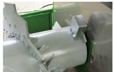
15 mm anchura del eje con 3 tornillos de fijación. El eje equilibrado asegura una larga vida útil.
