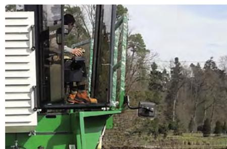
Espejo exterior para una visión óptima del rodillo.
