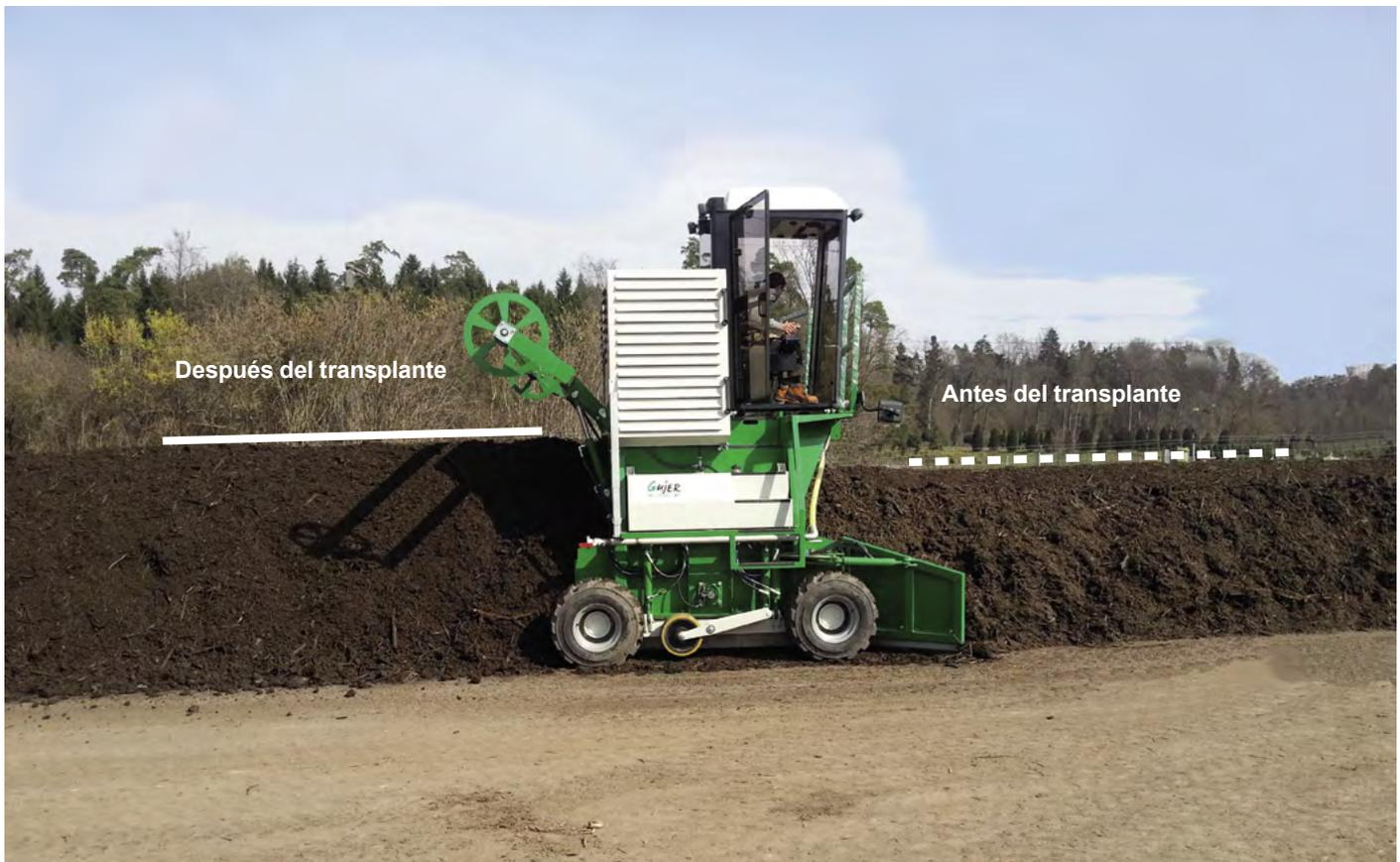
*Aflocamiento coherente, eficaz y eficiente del material de compost de modo que el oxígeno pueda circular de manera óptima. Proporcionamos un proceso de descomposición óptimo. Sobre la base de la línea blanca se puede ver claramente la relajación antes y después del trasplante.*
