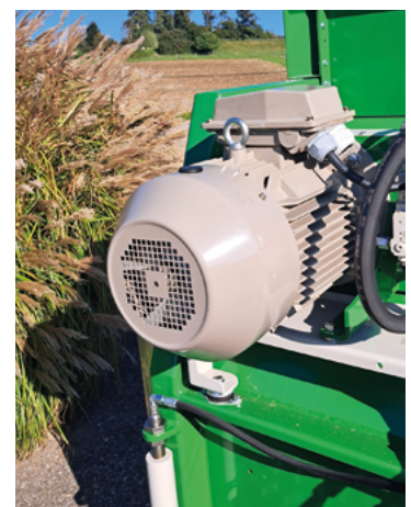
Elektro Motor 11kW
