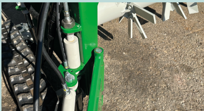
Einfache Höhenanpassung (12cm), damit die Walze nahe am Boden arbeitet und keine Faulschicht entsteht.
