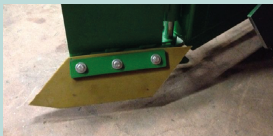
Gummi an den Zuführschildern (für befestigten Platz)
