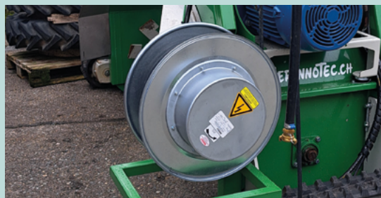
Kabeltrommel bis 80 m für Wasserschlauch oder Elektro Kabeltrommel.
