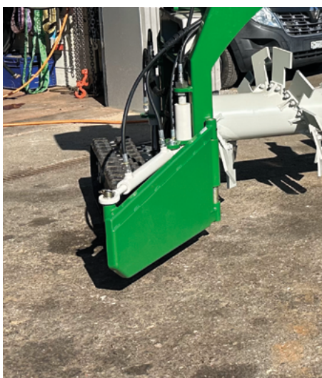
Zuführschild hydraulisch rechts & links auch bei Elektroantrieb. (Load Sensing Hydraulikpumpe)
