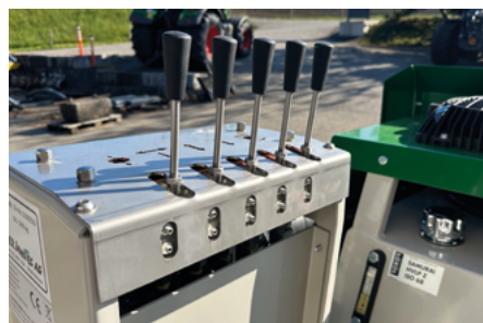
Fahrhebelbedienung wird in eingestellter Position gehalten.
