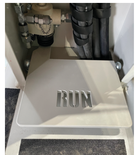
Notaus-Pedal ohne elektrische Installation.
