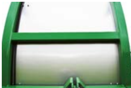
Todas las placas de desgaste están fabricadas de acero cromado.
