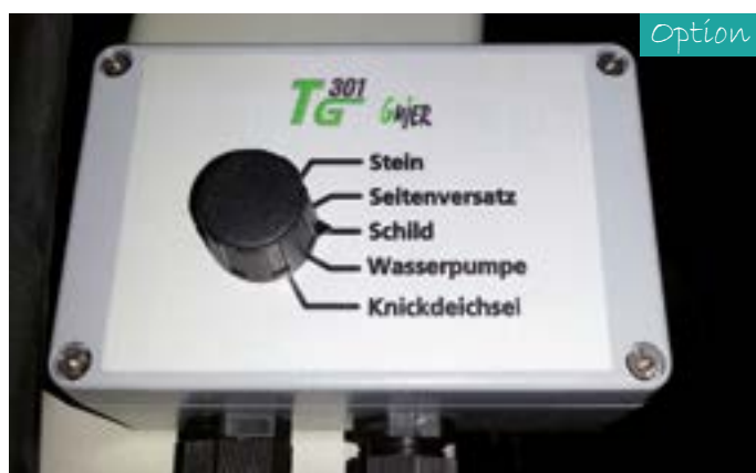
Fácil manejo a través de panel de control. Conmutación a través de electroválvulas.
