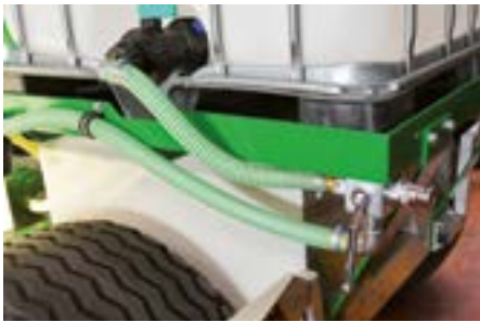
Posibilidad de aspiración de agua externa para la alimentación ajena.
