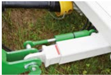
Sistema hidráulico de inclinación del túnel, para que la pila se quede en el sitio dónde pertenece.
