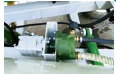
Bomba de agua
