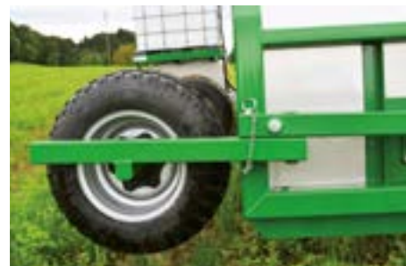
Para el transporte se puede girar hacia atrás a la rueda de soporte, no es necesario el desmontaje.
