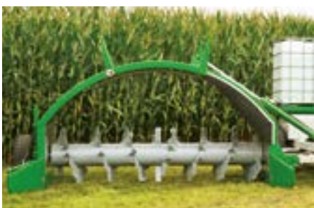
La masiva construcción del túnel con forma de bóveda y 6 mm de acero consigue una gran estabilidad.
