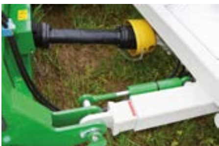
Accionamiento directo – engranaje sobre eje de volteo
