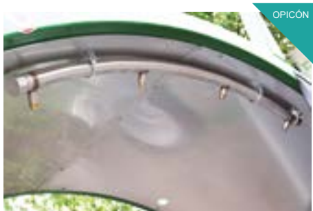
Barras aspersión de agua con pulverizadores. Para la obtención de un clima óptimo para los microorganismos dentro de la pila, la adición de agua es indispensable.
