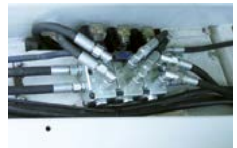
Válvula de control electrohidráulica con panel de control; (simple, doble o triple)
