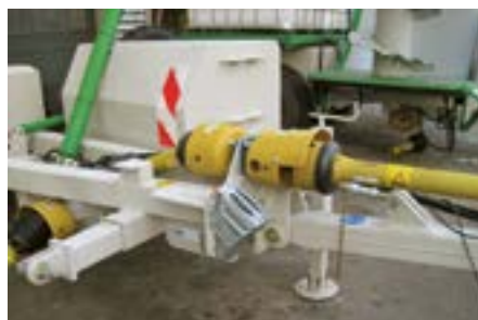
Enganche inferior para tracción baja para el tipo hitch con Piton o K80.
