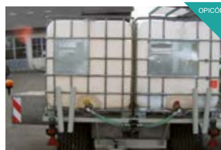
Depósito de agua doble
