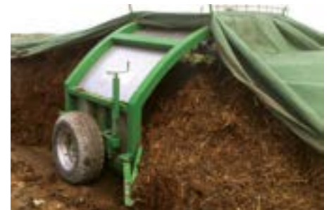
La tela de cubierta se junta en un ancho menor para que los gases puedan escaparse. Se evita el duro trabajo manual en caso de tela mojada.
