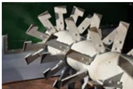
Un buen eje giratorio que voltea el interior hacia el exterior, para que los microorganismos puedan reproducirse en todas partes de forma óptima.
