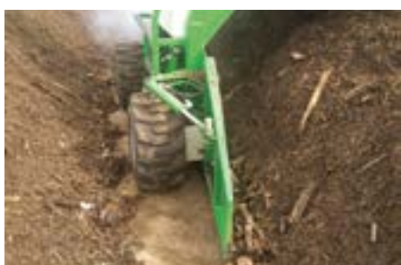
Les panneaux de ramassage indépendant sont géré hydrauliquement pour des passages bien propres.
