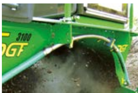
Système d'irrigation simple avec barre d'irrigation. Pour obtenir les conditions optimales pour les microorganismes un rajout de l'eau est indispensable.
