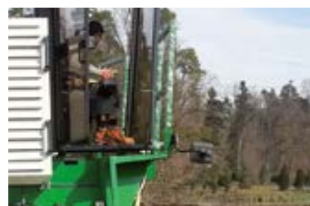
Rétroviseurs pour une vue dégagé sur le rotor.
